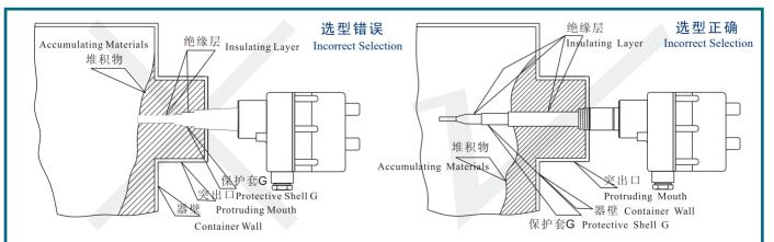
在测非导电液体或导电液体和泥浆时,以及在测粉末、颗粒状时,最佳为水平安装,如需要垂直安装时,探头长至少保持12″,水平安装仪表时,探头保护长套G必须伸到容器壁内2″。
