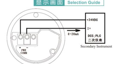
产品正常安装在设备上及信号回路按照图示接好后,必须根据实际物料的零点(低位)和满位(高位)高度,对仪表进行零点(低位)和满位(高位) 标定,才能正常测量(标定和测量的物料必须是同一种物料)。
